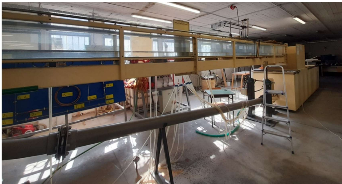
Εργαστηριακός ανοικτός αγωγός για την μελέτη ροών σε ανοικτούς αγωγούς
